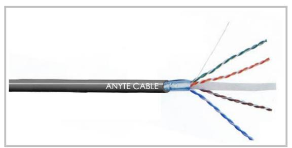
数字通信用水平对绞电缆,应用于大楼综合布线系统中工作区通信引出端与交接间的配线架之间的布线,以及住宅综合布线系统的用户通信引出端到配线架之间的布线,满足于 100MHz 的数据通信。按 ANSI/TIA/EIA-568-B 颜色编码标色。
