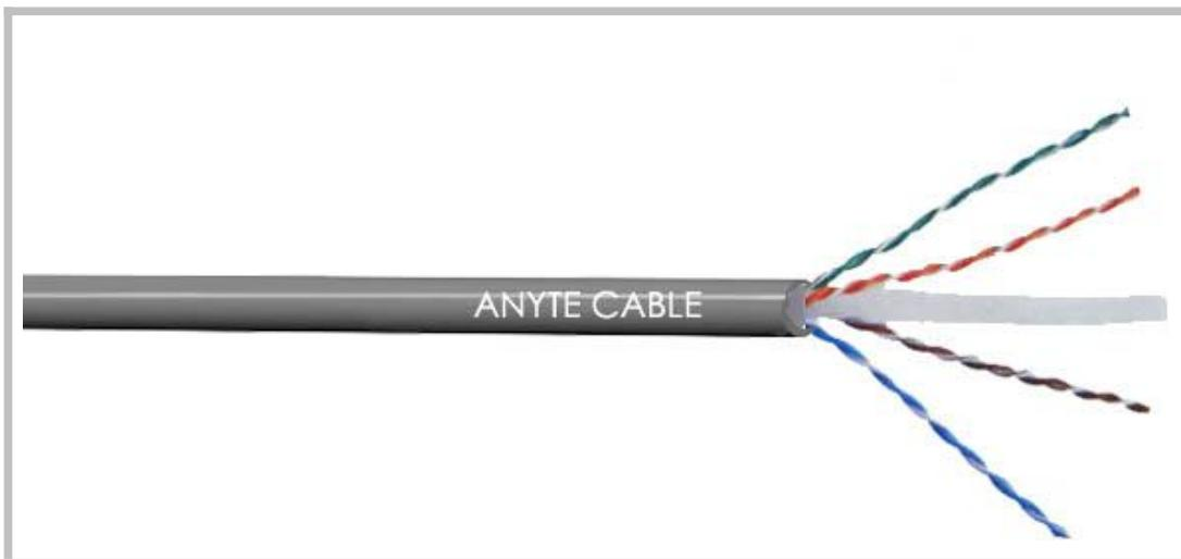
数字通信用水平对绞电缆，应用于大楼综合布线系统中工作区通信引出端与交接间的配线架之间的布线，以及住宅综合布线系统的用户通信引出端到配线架之间的布线，满足于 100MHz 的数据通信。按 ANSI/TIA/EIA-568-B 颜色编码标色。
